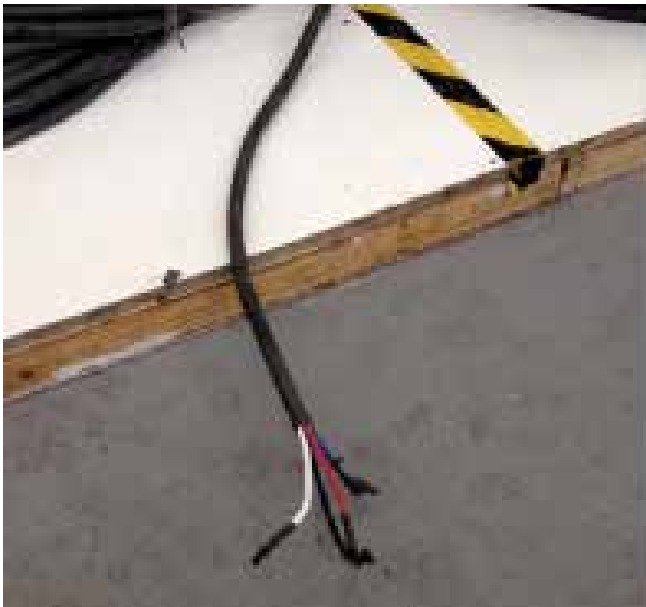
Ponta do cabo fornecido sem plug fêmea, para ser adaptado na ponteira da montadora
