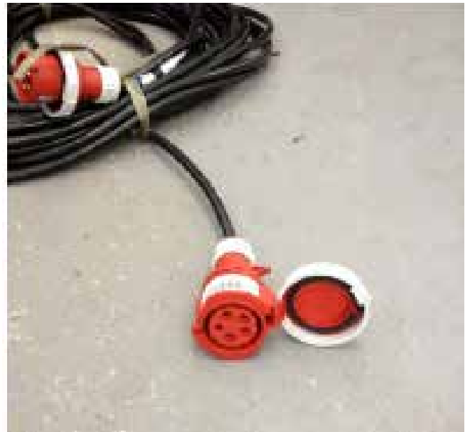
Ponta do cabo fornecido: Cabo fornecido com plugues fêmeas, para conexão com a ponteira do painel de distribuição
